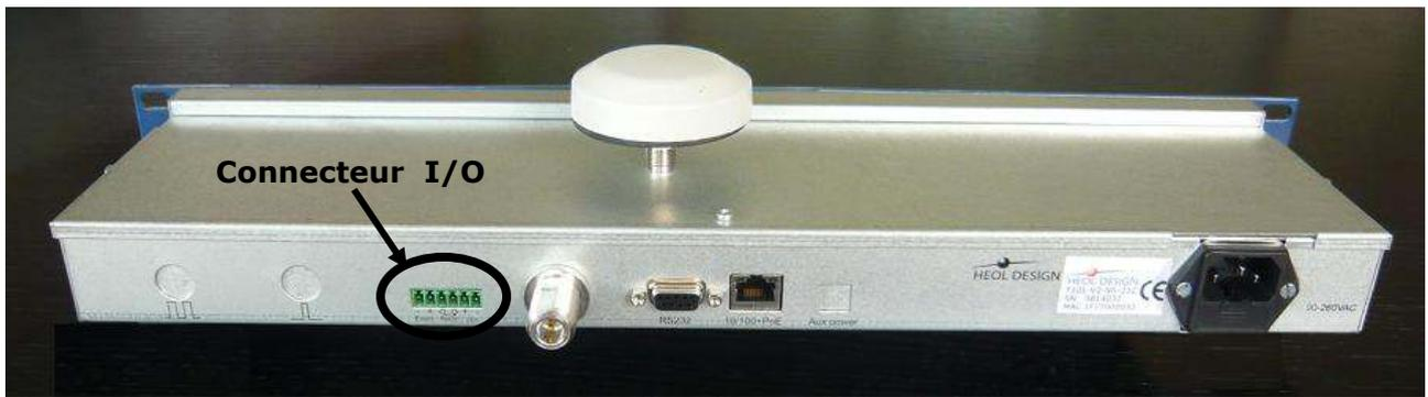
Vue arrière du T105, version rackable (avec connecteur d'antenne 'N').
