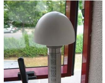
Grâce au mode self-survey, la précision du TimeStamp (horodatage des trames Ethernet) est de **±200 nanosecondes** en réception et **±600 nanosecondes** en émission par rapport à l'horloge atomique UTC (avec la version 1µs), et ce même si un seul satellite est disponible.
